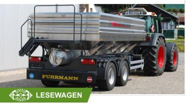
Lesewagen mit Förderschnecke und gerader Austragung oder mit Exzenterschneckenpumpe
