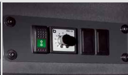
Übersichtlich angeordnete und gut zugängliche Bedienteile im Kabinendach
