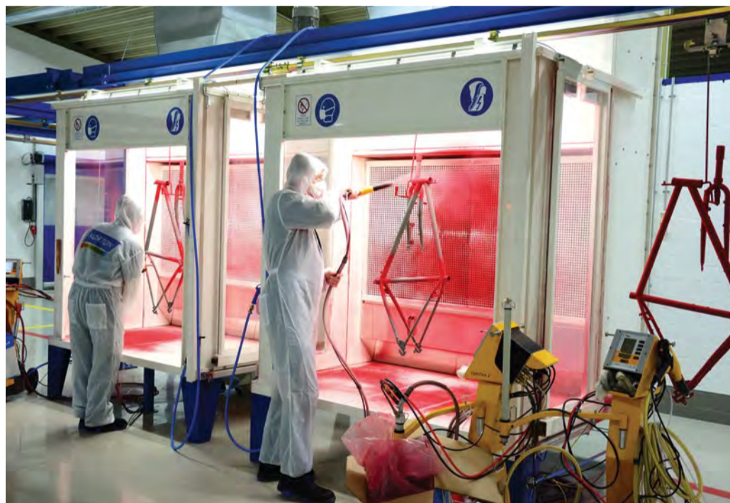
Die beiden Handbeschichterplätze sind für schnelle Farbwechsel zusätzlich mit einer Schnellwechsellpistole ausgestattet. Quelle: Meeh Jumbo-Coat.
